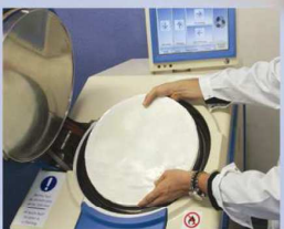
Ejection de la galette désinfectée, évacuation vers les déchets ménagers
